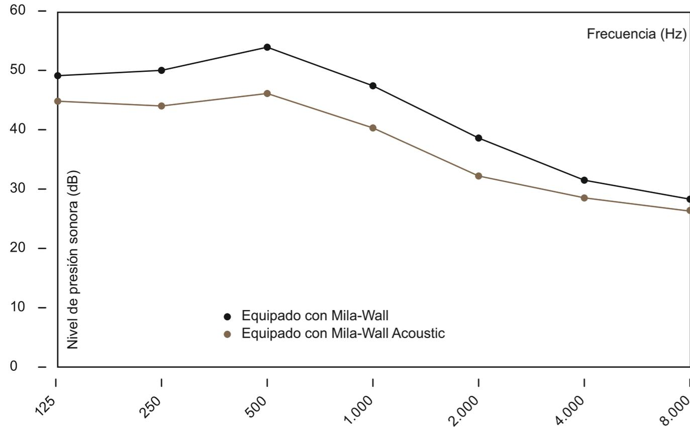
En una simulación del instituto Fraunhofer IBP se realizan pruebas con los paneles convencionales en comparación con los paneles Mila-Wall Acoustic. Los resultados de la reducción de la reverberación hablan por sí solos.
